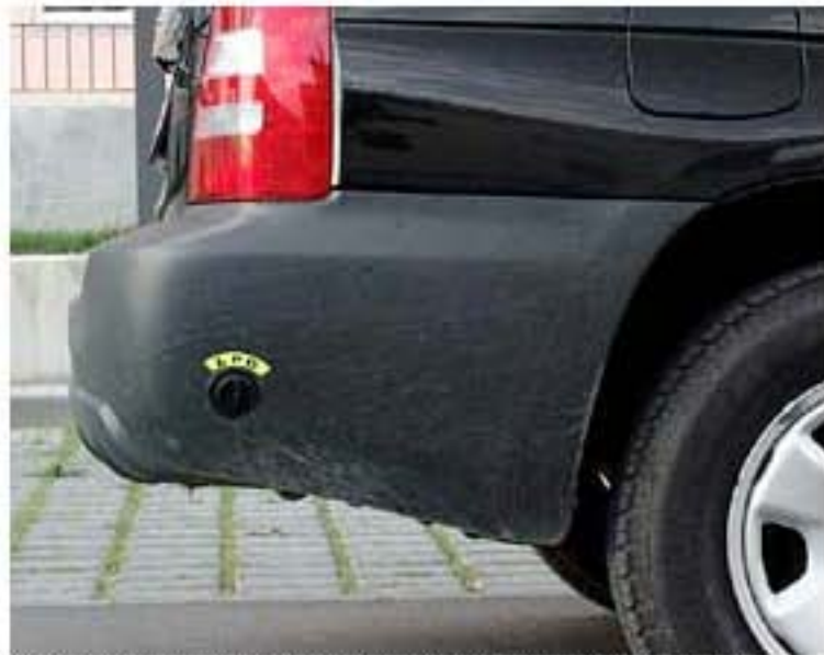
ALTERNATIVNÍ POHON LPG PROZRAZUJE JEN KLASICKÁ KRYTKA HRDLA PLYNOVÉ NÁDRŽI V ZADNÍM NÁRAZNÍKU.
